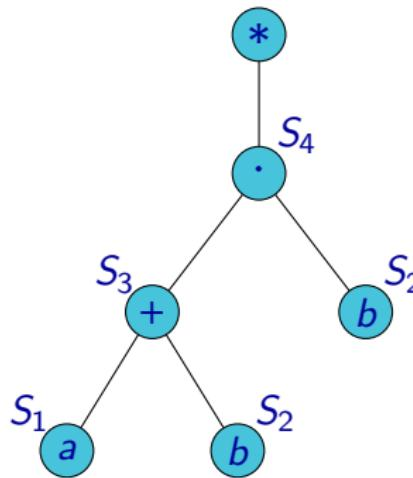
$$\begin{aligned}S_4 &\rightarrow S_3 S_2 \\S_3 &\rightarrow S_1 \mid S_2 \\S_2 &\rightarrow b \\S_1 &\rightarrow a\end{aligned}$$
